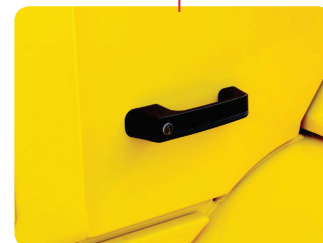
편리한 잠금장치 200종의 키를 적용하여 시동, 운전석, 연료캡, 워셔액 커버와 배터리 커버를 하나의 키로 잠글 수 있습니다.
